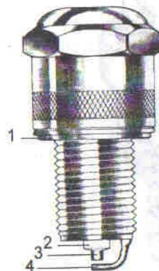
1 - Joint métalloplastique ; 2 - Isolant ; 3 - Electrode centrale ;
